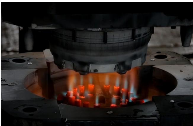
Готовый сплав подается в раздаточную печь литейной машины и наполняет пресс-форму жидким алюминием под низким давлением.
